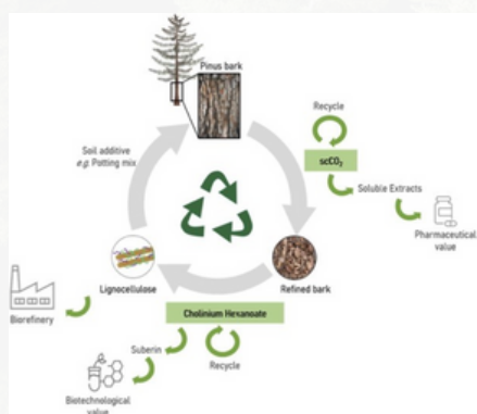
Figure 1. Modelo esquemático de uma potencial biorrefinaria de casca sustentável
